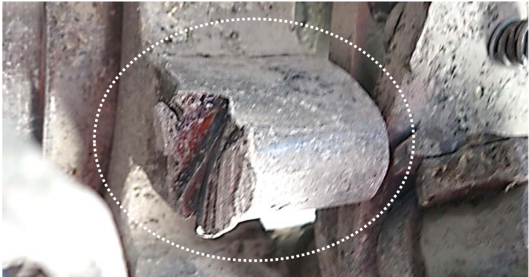
Abbildung 10: Ausbruch an einem Zahn des Bremszahnrad des Reisezugwagens Panorama As 103.
