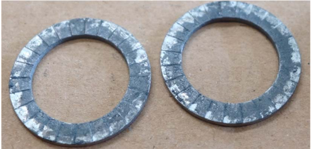
Abbildung 11: Die zwei Scheiben der Schraubensicherung Marke Nord Lock der gefundenen Schraube mit noch nicht abgenutzter Verzahnung.
