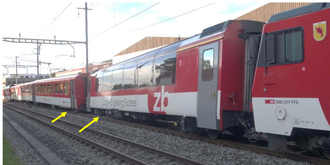
Abbildung 3: Situation nach dem Stillstand des Zuges. Die ersten beiden Wagen sind mit den gegenüberliegenden Laufdrehgestellen entgleist (Pfeile).
