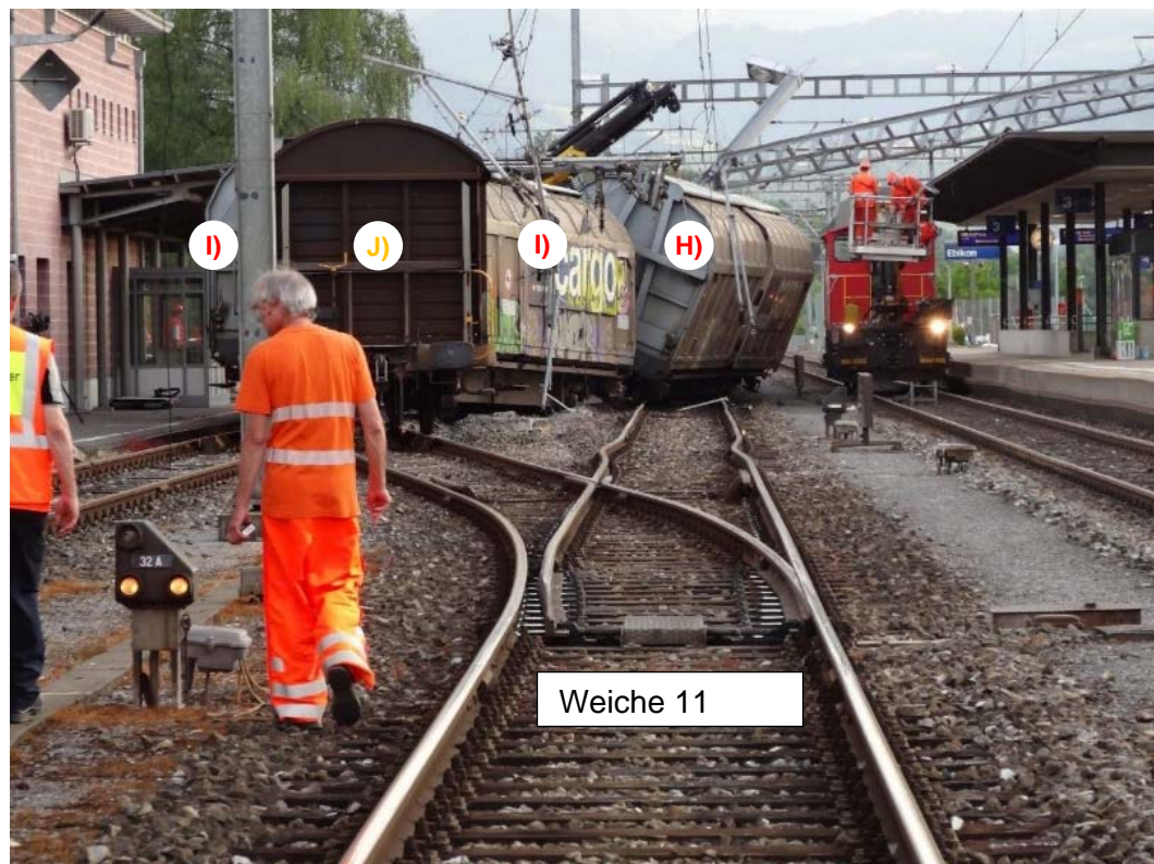
Abbildung 2: Sicht in Fahrtrichtung von Gleis 32 auf die Weiche 11, die nach dem Ereignis in ablenkender Stellung stand, sowie auf die letzten drei Güterwagen (H, I, J).
